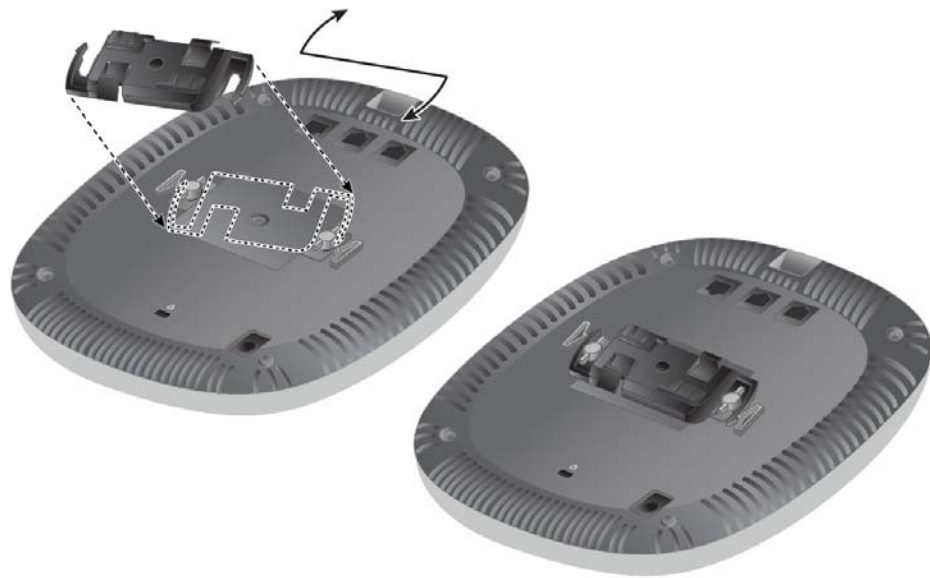
Gambar 6 Memasang Adaptor Rel Plafon
